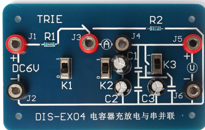
Рис.1 Плата для изучения последовательно-параллельной цепи конденсатора
