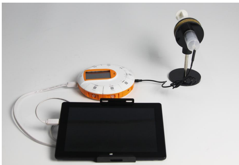
Рис.1: Установка для определения работы, совершаемой при сжатии газа
