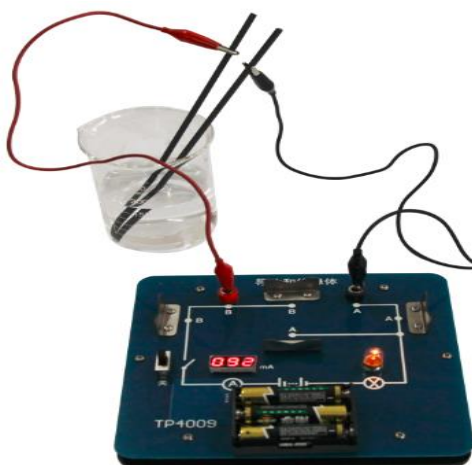
Рис. 3 В качестве проводника используется угольный стержень и солёная вода
