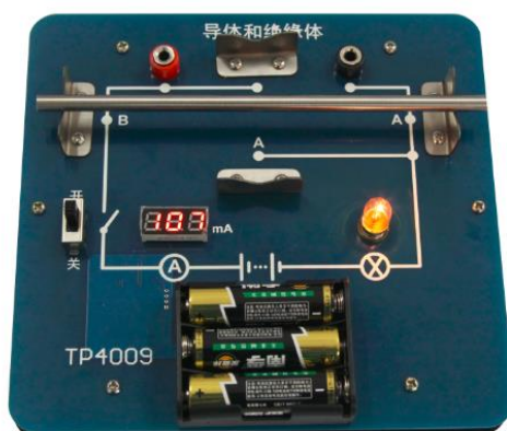
Рис. 2 В качестве проводника используется металлический прут из нержавеющей стали
