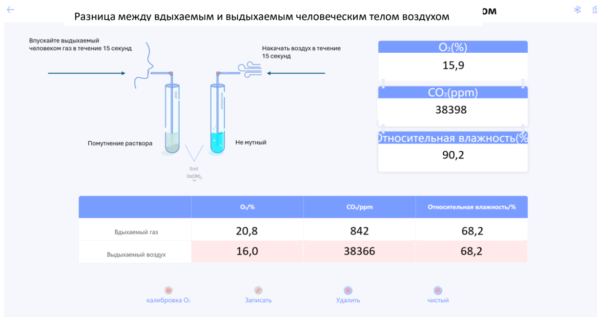
Рис. 3. Вдыхаемый воздух и выдыхаемый газ из организма человека
