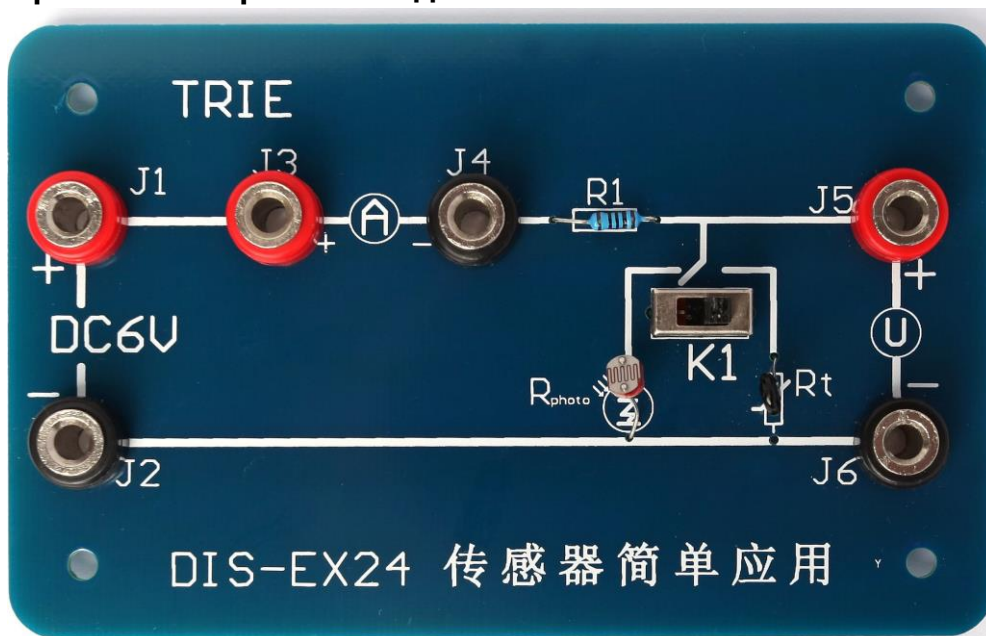
Рис. 1 Плата для изучения характеристик светочувствительного резистора и термистора
